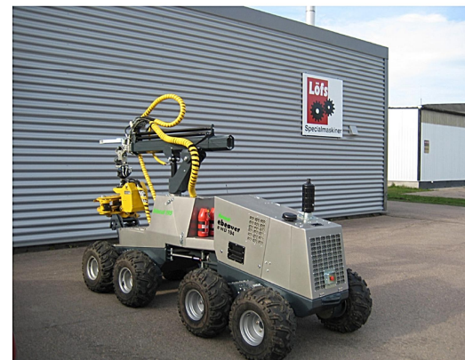
eBeaver, en fjärrmanövrerad energiskördare som konstruerats på Löfs Specialmaskiner.
